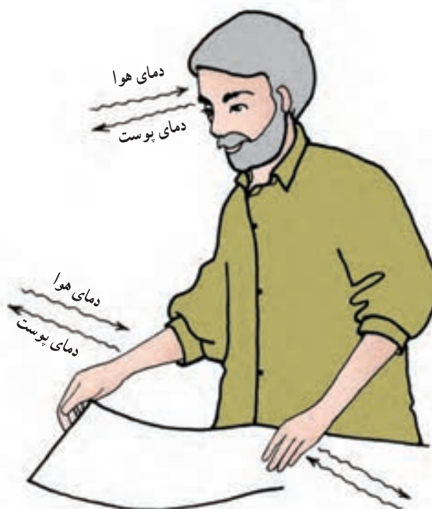
شکل ۱۳-۳ انتقال گرما از راه جابجایی
