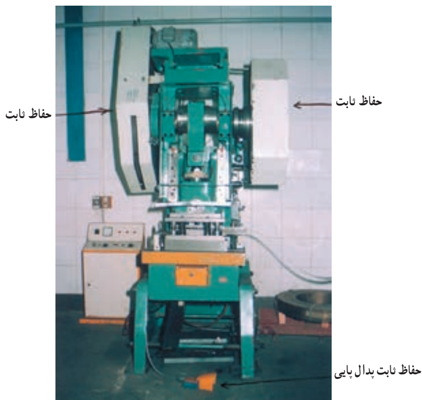
شکل ۹-۶- حفاظهای ثابت در محلهای گردان یک دستگاه پرس و حفاظ ثابت روی پدال پای
